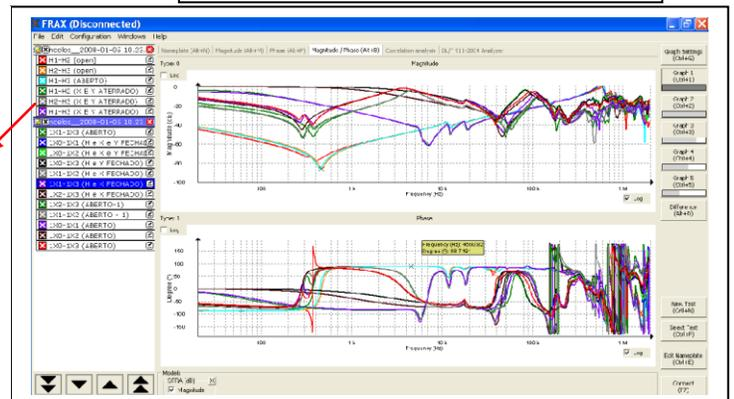
O Frax é capaz de medir / fornecer resultados tanto para amplitude quanto para a fase, permitindo a configuração dos modelos de análise e a realizar funções de transferência, em Magnitude, Fase, Admitância e Impedância em Transformadores e Autotransformadores:
