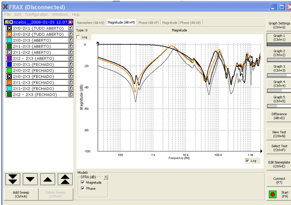
Seu software de análise gráfica possui métodos de correlação/comparação e também baseado na norma DL911/2004, que permite a comparação das curvas gráficas obtidas por meio de cálculo da comparação entre duas curvas distintas.
