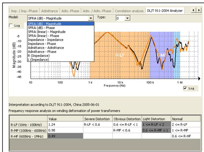
Através dos parâmetros e modelos de análise, o software permite a detecção visual das condições da amostra elas classificadas como: Normais, Distorções Leves, Distorções Obvias e Distorções Severas.
